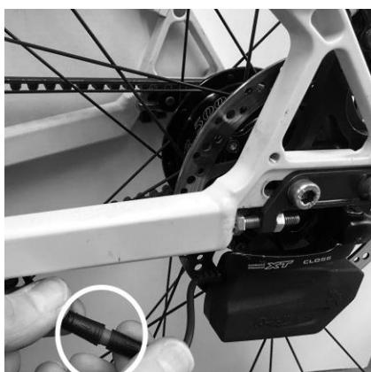
Steckverbindung der Rohloff E-14 Schalteinheit am Hinterrad trennen.
