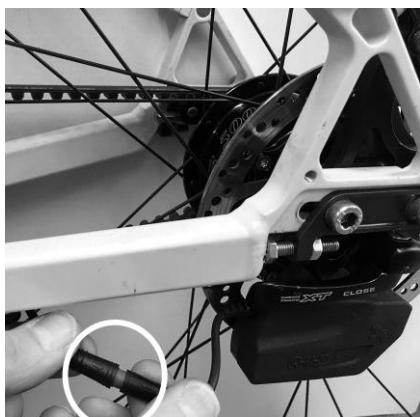
Déconnexion du branchement du E-14 au niveau de la roue arrière.
