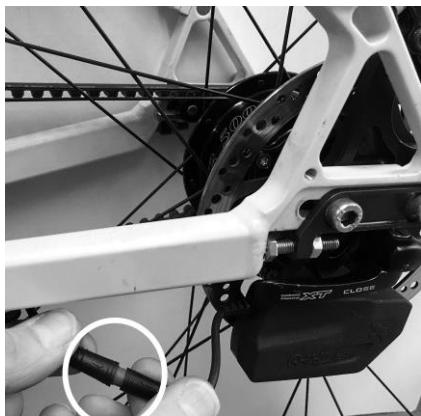
Stekkerverbinding van de Rohloff E-14 Schakeleenheid verbinden.
