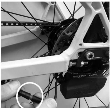
Steckverbindung der Rohloff E-14 Schalteinheit verbinden.
